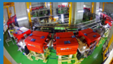
稀少RIリング。世界に類のないユニークな方式で質量を測る。
